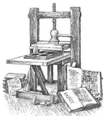
Рис. 9. Реконструированная модель печатного станка И. Гутенберга.
